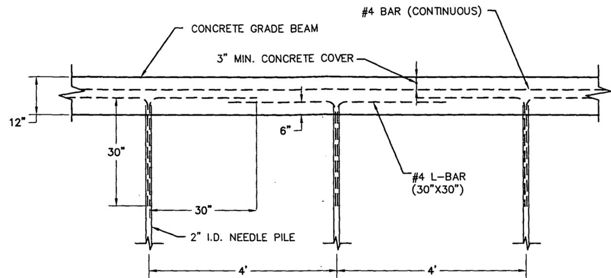
**GRADE BEAM/ NEEDLE PILE DETAIL**
